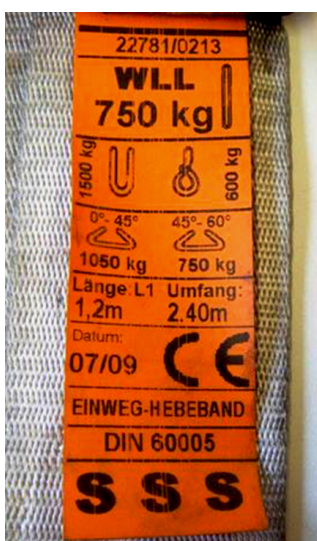
Abb. 8 Einweghebebänder nach DIN 60005
